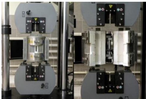
Rys. 1. Piec do badań wysokotemperaturowych. Fig. 1. Furnace for high-temperature testing.
