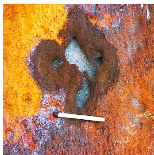
Rys.2. Przykłady perforacji w blachach podłogi analizowanego zbiornika Fig.2 Examples of the sheet perforation
